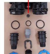
Durante l'assemblaggio della valvola, verificare sempre che ci sia la sfera di gomma, indispensabile per un corretto flusso dell'acqua in scarico durante i cicli di lavaggio.
