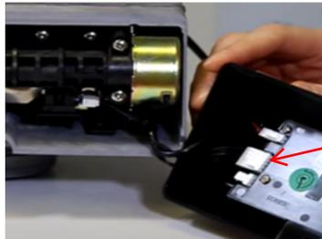
Attenzione nel movimentare il BOX elettronico per accedere alla vite di miscelazione, controllare i connettori di alimentazione siano inseriti correttamente .
